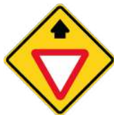
PROXIMIDAD DE SEÑAL "CEDA EL PASO"
