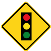
PROXIMIDAD DE SEMÁFORO
